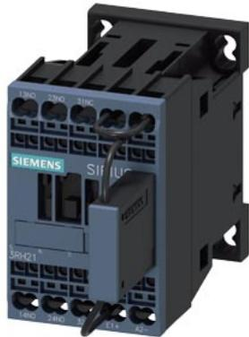
contattore ausiliario per impiego ferroviario, 2 NO + 1 NC, DC 220 V, 0,7 ... 1,25\* US, con diodo soppressore integrato, grandezza costruttiva S00, morsetto a molla adatto per uscite PLC
