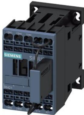
contattore ausiliario per impiego ferroviario, 2 NO + 2 NC DC 72 V, 0,7 ... 1,25\* US, con diodo soppressore integrato, grandezza costruttiva S00, morsetto a molla adatto per uscite PLC
