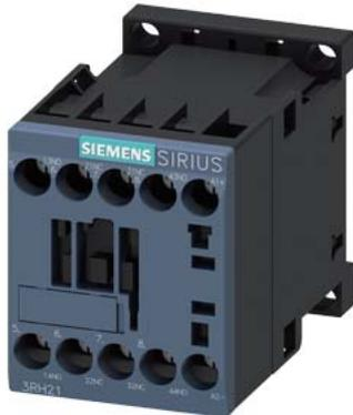
Contattore ausiliario per applicazioni ferroviarie 2NO + 2NC, DC 72-125V, 0,7...1,25\*US, con varistore integrato grandezza costruttiva S00, morsetto a vite adatto per uscite PLC
