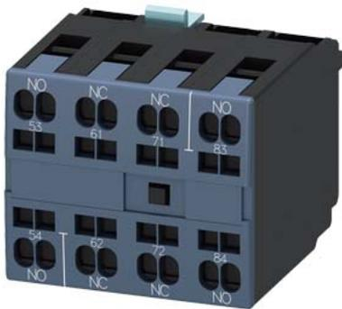
blocchetto di contatti ausiliari sul lato frontale, 2 NO 2 NC, morsetti a molla, per contattore 3RT1, numeri ordinali 5 ... 8
