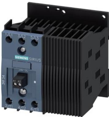
Contattore statico trifase 3RF3 AC 53 / 16 A / 40 °C AC 48-600 V / 110-230 V a comando bifase con commutazione istantanea morsetto a vite
