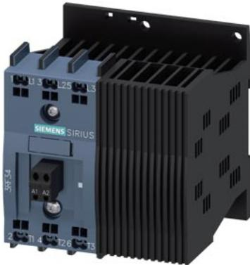
Contattore statico trifase 3RF3 AC 53 / 12,5 A / 40 °C AC 48-600 V / 110-230 V a comando bifase con commutazione istantanea morsetto a molla
