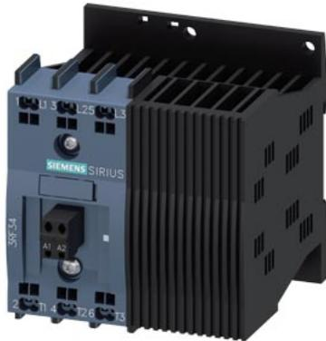
Contattore statico trifase 3RF3 AC 53 / 9,2 A / 40 °C 48-600 V / DC 24 V a comando bifase con commutazione istantanea morsetto a molla
