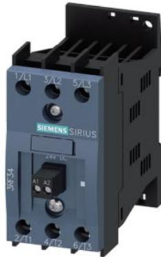
Contattore statico trifase 3RF3 AC 53 / 5,2 A / 40 °C AC 48-480 V / 110-230 V a comando bifase con commutazione istantanea morsetto a vite
