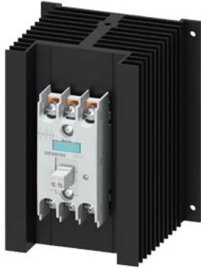
Contattore statico trifase 3RF2 AC 51 / 50 A / 40 °C 48-600 V / DC 4-30 V a comando trifase capocorda ad occhiello tensione di interdizione 1200 V
