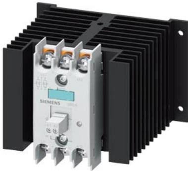
Contattore statico trifase 3RF2 AC 51 / 50 A / 40 °C 48-600 V / DC 4-30 V a comando bifase capocorda ad occhiello tensione di interdizione 1200 V
