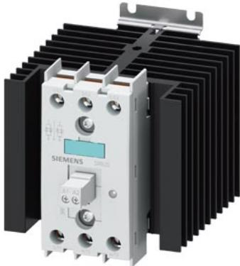
Contattore statico trifase 3RF2 AC 51 / 40 A / 40 °C AC 48-600 V / 110 V a comando bifase morsetto a vite tensione di interdizione 1200 V
