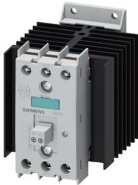
Contattore statico trifase 3RF2 AC 51 / 30 A / 40 °C 48-600 V / DC 4-30 V a comando bifase morsetto a vite tensione di interdizione 1200 V
