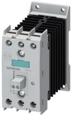
Contattore statico trifase 3RF2 AC 51 / 20 A / 40 °C AC 48-600 V / 230 V a comando bifase morsetto a vite tensione di interdizione 1200 V
