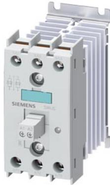
Contattore statico trifase 3RF2 AC 51 / 10 A / 40 °C AC 48-600 V / 110 V a comando bifase morsetto a vite tensione di interdizione 1200 V
