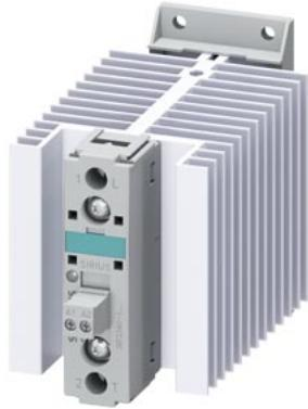
contattore statico monofase 3RF2 AC 51 / 40 A / 40 °C AC 48-600 V / 110-230 V
