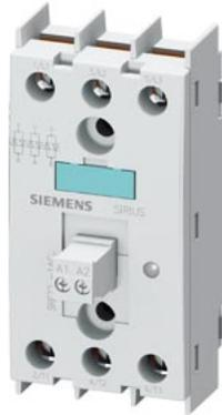
relè statico, trifase 3RF2 55 A / 40 °C AC 48-600 V / 110 V a comando trifase morsetto a vite tensione di interdizione 1200 V
