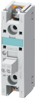
relè statico, monofase 3RF2 larghezza costruttiva 22,5 mm, 90 A AC 48-460 V / 110-230 V capocorda ad occhiello
