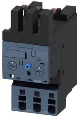
relè di sovraccarico 1...4 A elettronico per protezione motore grandezza costruttiva S0, CLASS 5...30 montaggio su contattore circuito principale: morsetto a molla circuito ausiliario: morsetto a molla reset manuale-automatico rilevamento di guasto verso terra interno
