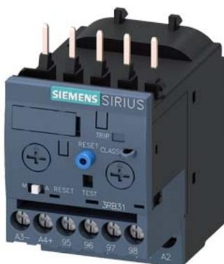
relè di sovraccarico 4...16 A elettronico per protezione motore grandezza costruttiva S00, CLASS 5...30 montaggio su contattore circuito principale: a vite circuito ausiliario: a vite reset manuale-automatico rilevamento di guasto verso terra interno
