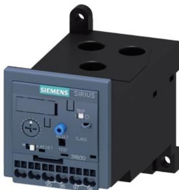
relè di sovraccarico 20...80 A elettronico per protezione motore grandezza costruttiva S2, CLASS 10E montaggio separato circuito principale: trasformatore a foro passante circuito ausiliario: morsetto a molla reset manuale-automatico
