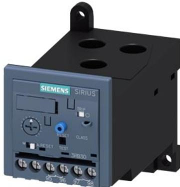
relè di sovraccarico 20...80 A elettronico per protezione motore grandezza costruttiva S2, CLASS 10E montaggio separato circuito principale: trasformatore a foro passante circuito ausiliario: a vite reset manuale-automatico
