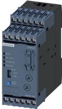
unità di analisi per protezione completa del motore (bistabile) grandezza costruttiva S00...S12, Classe 5...30 montaggio separato circuito principale: -- circuito ausiliario: morsetti a vite reset manuale-automatico
