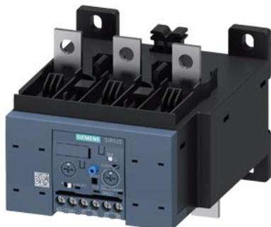
relè di sovraccarico 50 ... 200 A per protezione motore grandezza costruttiva S6, classe 5...30E montaggio contattore/montaggio separato circuito principale: collegamento per sbarre circuito ausiliario: morsetti a vite reset manuale-automatico rilevamento di guasto verso terra interno
