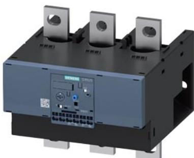
relè di sovraccarico 55 ... 250 A per protezione motore grandezza costruttiva S10/S12, classe 20E montaggio contattore/montaggio separato circuito principale: collegamento per sbarre circuito ausiliario: morsetto a molla reset manuale-automatico
