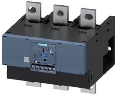
relè di sovraccarico 55 ... 250 A per protezione motore grandezza costruttiva S10/S12, classe 10E montaggio contattore/montaggio separato circuito principale: collegamento per sbarre circuito ausiliario: morsetti a vite reset manuale-automatico
