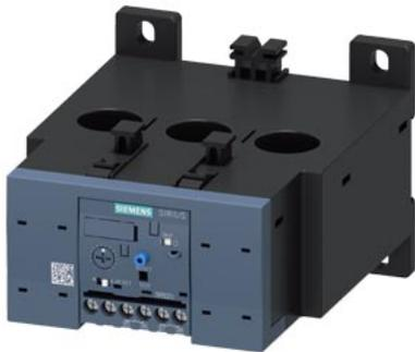
relè di sovraccarico 50 ... 200 A per protezione motore grandezza costruttiva S6, CLASS 10E montaggio contattore/montaggio separato circuito principale: trasformatore a foro passante circuito ausiliario: morsetti a vite reset manuale-automatico
