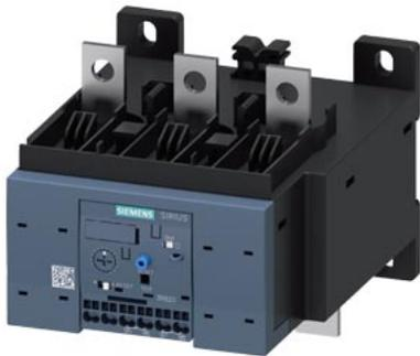
relè di sovraccarico 50 ... 200 A per protezione motore grandezza costruttiva S6, CLASS 10E montaggio contattore/montaggio separato circuito principale: collegamento per sbarre circuito ausiliario: morsetto a molla reset manuale-automatico
