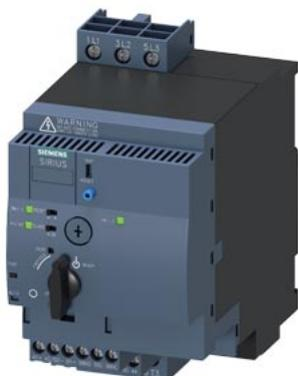
SIRIUS partenza compatta avviatore invertitore 400 V AC/DC 110 ... 240 V 50 ... 60 Hz 8 ... 32 A IP20 collegamento circuito principale: morsetto a vite collegamento del circuito di comando: morsetto a vite
