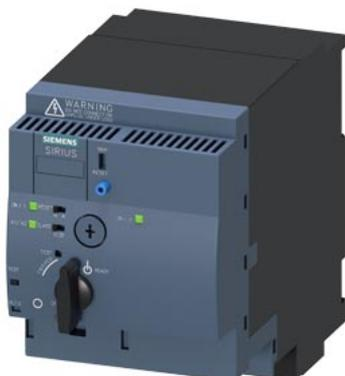
SIRIUS partenza compatta avviatore invertitore 690 V AC/DC 110 ... 240 V 50 ... 60 Hz 0,32 ... 1,25 A IP20 collegamento circuito principale: inseribile, senza morsetti collegamento del circuito di comando: inseribile, senza morsetti
