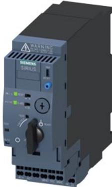
SIRIUS partenza compatta avviatore diretto 690 V AC/DC 110 ... 240 V 50 ... 60 Hz 1 ... 4 A IP20 collegamento circuito principale: inseribile, senza morsetti collegamento circuito ausiliario: morsetti a molla
