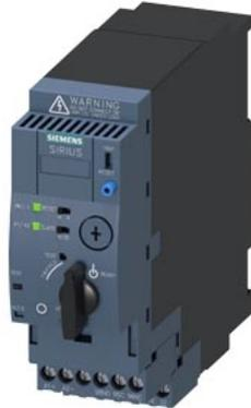
SIRIUS partenza compatta avviatore diretto 690 V AC/DC 110 ... 240 V 50 ... 60 Hz 8 ... 32 A IP20 collegamento circuito principale: inseribile, senza morsetti
