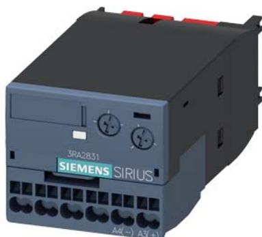
relè elettronico a tempo, ritardato all'eccitazione, con uscita statica, intervallo di tempo 0,05...100 s, AC/DC 24...90 V, 50/60 Hz, varistore per lo smorzamento delle bobine del contattore integrato, morsetti a molla, innestabile a scatto sul lato frontale per contattori 3RT203 / 3RT204
