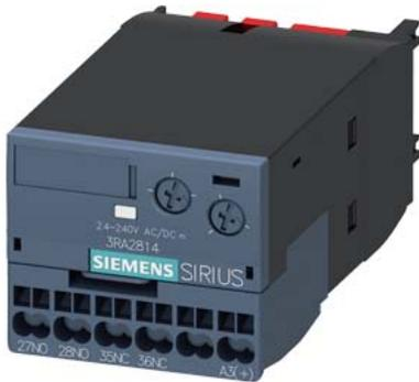
blocchetto di contatti ausiliari ritardato elettronicamente blocchetto di contatti ausiliari, ritardato alla diseccitazione, con segnale di comando, relè 1 NC + 1 NO, intervallo di tempo 0,05...100 s, AC/DC 24...240 V, 50/60 Hz, varistore per lo smorzamento delle bobine del contattore integrato, morsetti a molla, innestabile a scatto sul lato frontale per contattori 3RT20 e contattori ausiliari 3RH2
