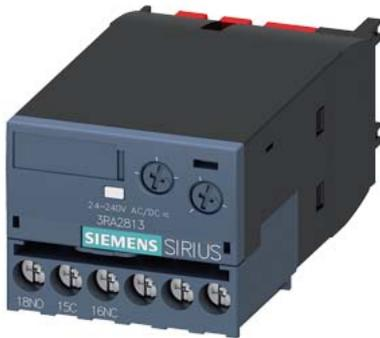
blocchetto di contatti ausiliari ritardato elettronicamente blocchetto di contatti ausiliari, ritardato all'eccitazione, relè: 1 CO, intervallo di tempo 0,05...100 s, AC/DC 24...240 V, 50/60 Hz, varistore per lo smorzamento delle bobine del contattore integrato, morsetti a vite, innestabile a scatto sul lato frontale per contattori 3RT20 e contattori ausiliari 3RH2
