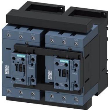
teleinvertitore, AC-3e/AC-3, 110 A, 55 kW / 400 V, a 3 poli, AC/DC 20...33 V, 50/60 Hz, morsetti a vite, interblocco elettrico e meccanico interblocco, contatti ausiliari: 2 x 1 NO, con presa di tensione per 3RA27
