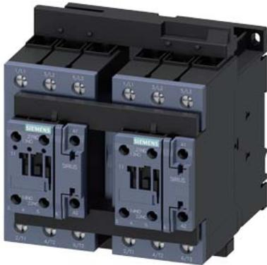
teleinvertitore, AC-3e/AC-3, 80 A, 37 kW / 400 V, a 3 poli, AC/DC 20...33 V, 50/60 Hz, morsetti a vite, interblocco elettrico e meccanico interblocco, contatti ausiliari: 2 x 1 NO, con presa di tensione per 3RA27
