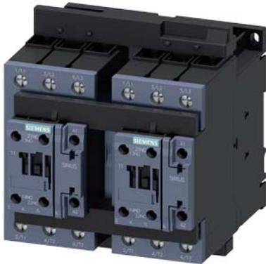
teleinvertitore, AC-3e/AC-3, 65 A, 30 kW / 400 V, a 3 poli, DC 24 V, 0,7...1,25\* US, con varistore innestato, morsetti a vite, interblocco elettrico e meccanico interblocco, contatti ausiliari: 2 x 1 NO
