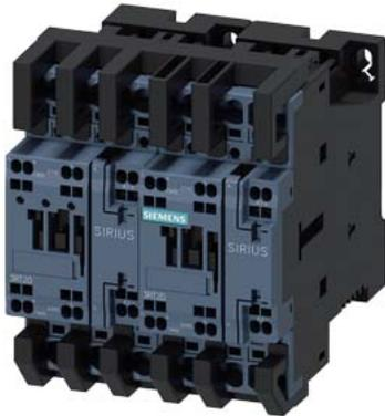
teleinvertitore, AC-3e/AC-3, 12 A, 5,5 kW / 400 V, a 3 poli, DC 24 V, morsetti a molla, interblocco elettrico e meccanico interblocco, contatti ausiliari: 2 x 1 NO, con presa di tensione per 3RA27
