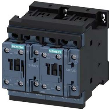
teleinvertitore, AC-3e/AC-3, 9 A, 4 kW / 400 V, a 3 poli, DC 24 V, morsetti a vite, interblocco elettrico e meccanico interblocco, contatti ausiliari: 2 x 1 NO
