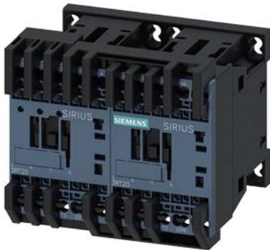
teleinvertitore, AC-3e/AC-3, 16 A, 7,5 kW / 400 V, a 3 poli, DC 24 V, morsetti a molla, interblocco elettrico e meccanico interblocco, con presa di tensione per 3RA27
