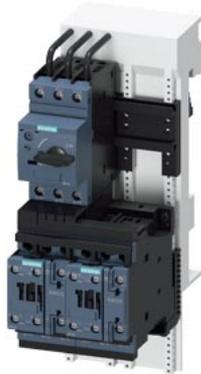
partenza senza fusibili, funzionamento con inversione AC 400 V, grandezza costruttiva S0 23,0 ... 28,0 A DC 24 V morsetti a vite per sistema a sbarre collettive 60 mm (conformemente anche al tipo di coordinamento 1) tipo di coordinamento 2, I<sub>q</sub> = 150 kA 1 NO+1 NC (contattore)
