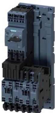
partenza senza fusibili, funzionamento con inversione AC 400 V, grandezza costruttiva S0 7,00 ... 10,0 A AC 230 V morsetti a molla per montaggio su guida DIN con adattatore per guida DIN (conformemente anche al tipo di coordinamento 1) tipo di coordinamento 2, I<sub>q</sub> = 150 kA 1 NO+1 NC (contattore)
