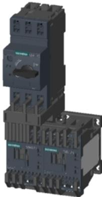
partenza senza fusibili, funzionamento con inversione AC 400 V, grandezza costruttiva S00 0,70 ... 1,00 A DC 24 V morsetti a molla per montaggio su guida DIN (conformemente anche al tipo di coordinamento 1) tipo di coordinamento 2, I<sub>q</sub> = 150 kA 1 NC (contattore)
