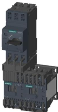
partenza senza fusibili, funzionamento con inversione AC 400 V, grandezza costruttiva S00 0,70 ... 1,00 A AC 230 V morsetti a molla per montaggio su guida DIN (conformemente anche al tipo di coordinamento 1) tipo di coordinamento 2, Iq = 150 kA 1 NC (contattore)
