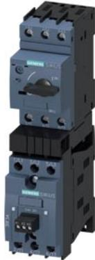
partenza senza fusibili, funzionamento con inversione AC 400 V, grandezza costruttiva S00 0,70 ... 1,00 A DC 24 V morsetti a vite per montaggio su guida DIN tipo di coordinamento 1, I<sub>q</sub> = 50 kA
