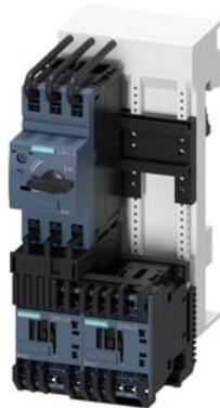
partenza senza fusibili, funzionamento con inversione AC 400 V, grandezza costruttiva S00 0,28 ... 0,40 A DC 24 V morsetti a molla per sistema a sbarre collettive 60 mm (conformemente anche al tipo di coordinamento 1) tipo di coordinamento 2, I<sub>q</sub> = 150 kA 1 NC (contattore) lunghezza adattatore 200 mm lunghezza adattatore 200 mm
