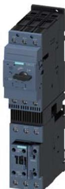
partenza senza fusibili, avviamento diretto AC 400 V, grandezza costruttiva S2 62 ... 65 A AC 230 V, 50 Hz morsetti a vite per montaggio su guida DIN (conformemente anche al tipo di coordinamento 1) tipo di coordinamento 2, Iq = 150 kA 1 NO+1 NC (contattore)
