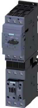
partenza senza fusibili, avviamento diretto AC 400 V, grandezza costruttiva S2 49 ... 59 A AC 230 V, 50 Hz morsetti a vite per montaggio su guida DIN (conformemente anche al tipo di coordinamento 1) tipo di coordinamento 2, I<sub>q</sub> = 100 kA 1 NO+1 NC (contattore)
