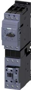
partenza senza fusibili, avviamento diretto AC 400 V, grandezza costruttiva S2 22 ... 32 A AC 230 V, 50 Hz morsetti a vite per montaggio su guida DIN (conformemente anche al tipo di coordinamento 1) tipo di coordinamento 2, I<sub>q</sub> = 100 kA 1 NO+1 NC (contattore)
