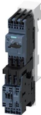
partenza senza fusibili, avviamento diretto AC 400 V, grandezza costruttiva S0 13 ... 20 A morsetti a molla per sistema a sbarre collettrici 60 mm (conformemente anche al tipo di coordinamento 1) tipo di coordinamento 2, I<sub>q</sub> = 150 kA 1 NO+1 NC (contattore)
